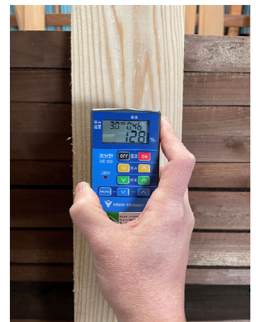
含水率計を用いて含水率を測定
