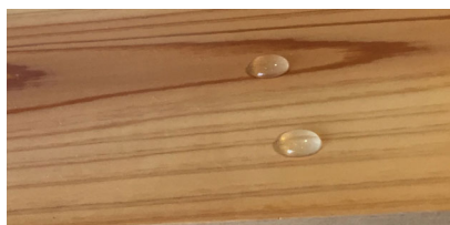
植物油原料の塗装をした 木材の撥水の状態
