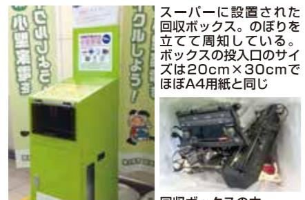
スーパーに設置された回収ボックス。のぼりを立てて周知している。ボックスの投入口のサイズは20cm×30cmでほぼA4用紙と同じ
