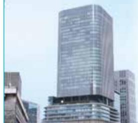
2010年秋に誕生した、中之島フェスティバルタワーは、「水都・大阪」の利点をいかした河川水利用の地域冷暖房システムや、13階のスカイロビー、LED照明、中水利用設備など多彩な環境設備が整えられ、国土交通省の平成21年度「住宅・建築物省CO2推進モデル事業」にも選ばれました。次世代の環境術ともいえるその取組みを紹介します。
